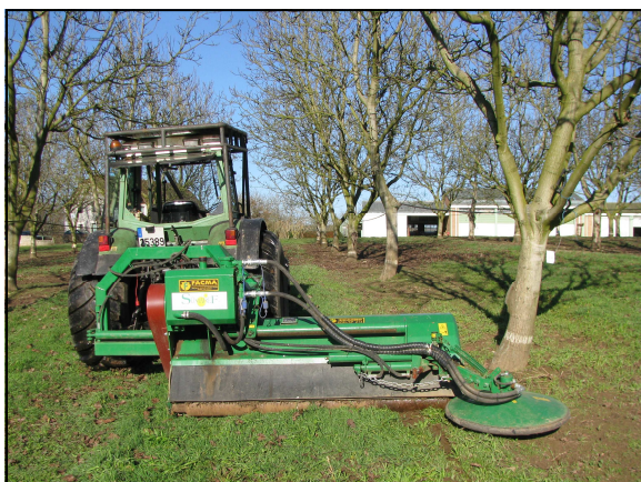
Broyeur avec déport important et satellite hydraulique pour le fauchage sur le rang
