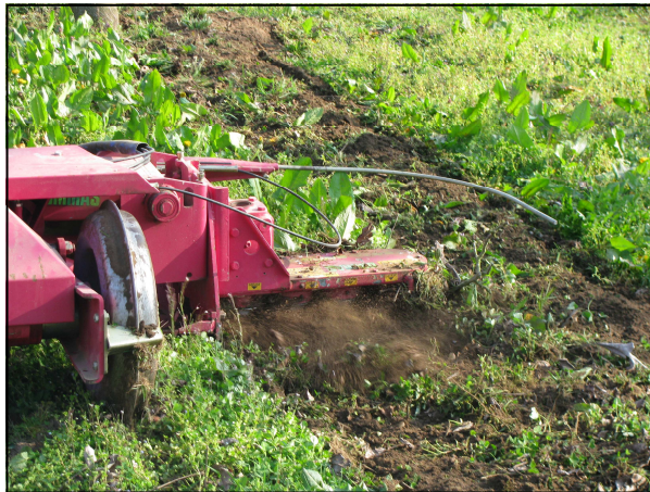
Herse rotative avec système d'effacement électro-hydraulique
